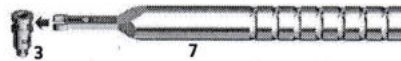
Hình C – Gắn Bộ dẫn hướng khoan khắc phục vào Tay cầm của vòng khắc phục Implant
