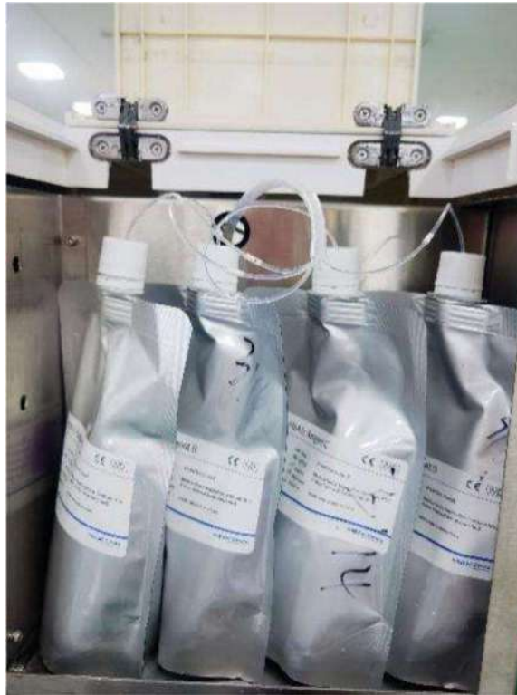
(Hình ảnh: Các túi thuốc thử A, B, C, D được lắp đặt)
