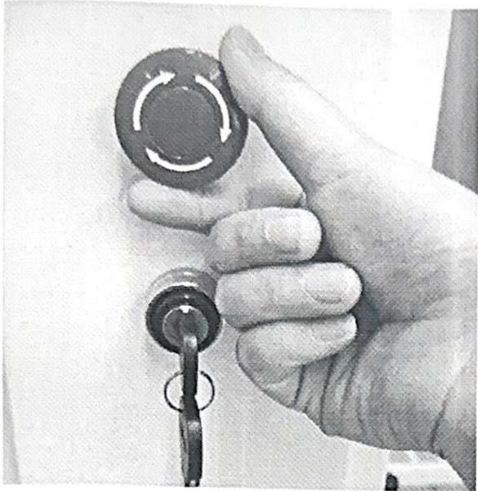
Bước 3: Nhả nút dừng khẩn cấp màu đỏ, cắm công tắc khóa và bật máy.
