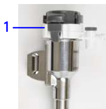
Hình 11.20 Gắn chính xác ống nối chuyển tiếp và vòng đệm ống thông dò
