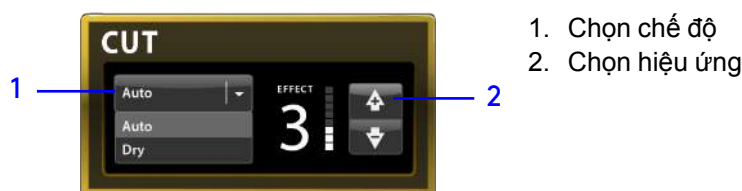
Hình 6.10 Cài đặt chế độ và hiệu ứng, CUT đơn cực
