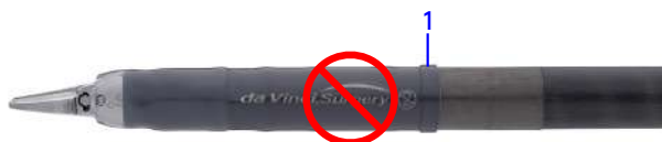
Hình 7.4 Nắp bọc đầu được lắp quá sâu
