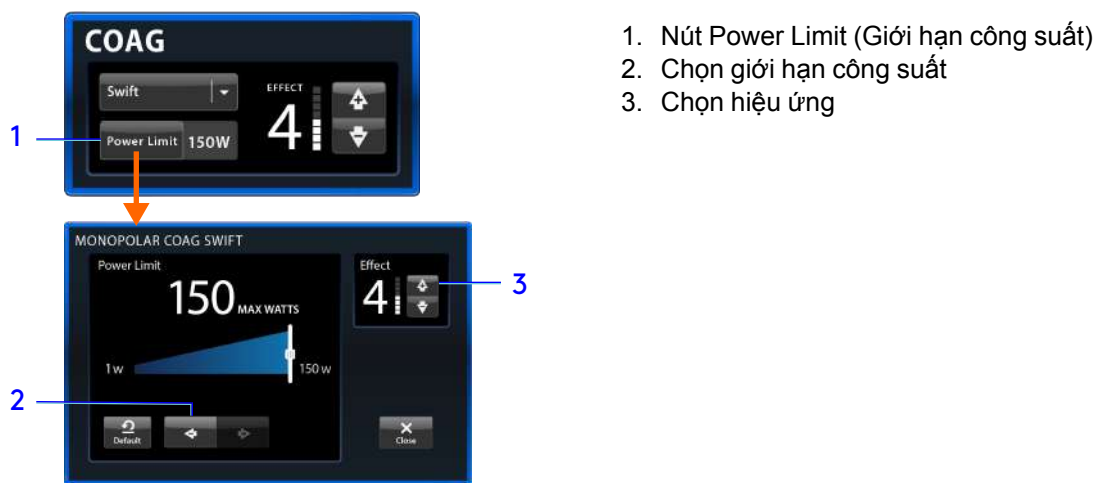
Hình 6.12 Cài đặt giới hạn công suất, ví dụ trong chế độ COAG đơn cực
