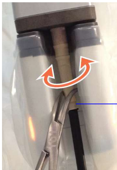
Hình 2.6 Sử dụng kẹp, vận bánh răng trong khi giữ trục cố định tại vị trí
