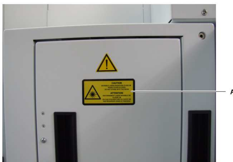
Mở nắp Nhãn cảnh báo LASER được gắn vào cửa bảo trì khu vực mở nắp, ở mặt sau của máy. B Nhãn cảnh báo Hình A-11 Nhãn cảnh báo LASER
